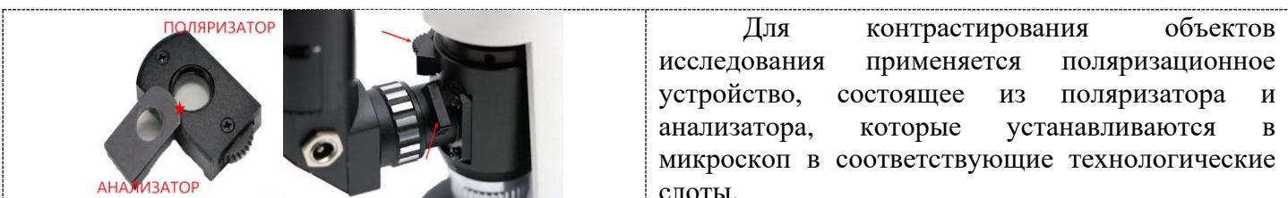
Для контрастирования объектов исследования применяется поляризационное устройство, состоящее из поляризатора и анализатора, которые устанавливаются в микроскоп в соответствующие технологические слоты.
