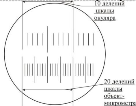
Калибровка производится путём сопоставления окулярной шкалы с эталонной, расположенной на объект-микрометре (рис.5.1). Для этого, вместо испытуемого объекта поместить под основание микроскопа объект-микрометр, найти его шкалу и совместить её со шкалой окуляр-микрометра (рис.5.2). Развернуть объект-микрометр (или окуляр) так, чтобы штрихи объект-микрометра были направлены параллельно штрихам шкалы окуляра.
